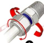
3 Aplique torque en sentido de las manecillas del reloj y deténgase al ver o escuchar que el anillo rojo se desprende del conector
