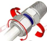
3 Aplique torque en sentido de las manecillas del reloj y deténgase al ver o escuchar que el anillo rojo se desprende del conector
