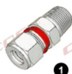
1 Verificar que el tubing a utilizar esté cortado a 90° y esté libre de viruta, asegúrese que el conector cuenta con los dos ferrules y que se encuentren en la orientación correcta
