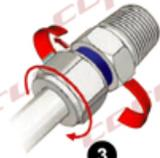
3 Aplique torque en sentido de las manecillas del reloj y deténgase al ver o escuchar que el anillo rojo se desprende del conector
