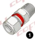
1 Verificar que el tubing a utilizar esté cortado a 90° y esté libre de viruta, asegúrese que el conector cuenta con los dos ferrules y que se encuentren en la orientación correcta
