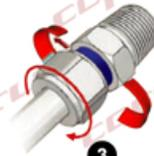
Aplique torque en sentido de las manecillas del reloj y deténgase al ver o escuchar que el anillo rojo se desprende del conector
