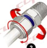
Aplique torque en sentido de las manecillas del reloj y deténgase al ver o escuchar que el anillo rojo se desprende del conector
