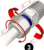
Aplique torque en sentido de las manecillas del reloj y deténgase al ver o escuchar que el anillo rojo se desprende del conector
