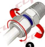
3 Aplique torque en sentido de las manecillas del reloj y deténgase al ver o escuchar que el anillo rojo se desprende del conector
