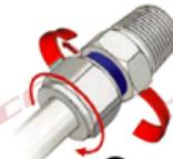
3 Aplique torque en sentido de las manecillas del reloj y deténgase al ver o escuchar que el anillo rojo se desprende del conector
