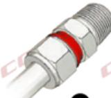
2 Inserte el tubing hasta el fondo del conector y apriete la tuerca con los dedos firmemente
