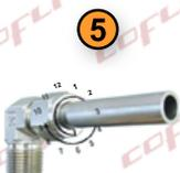
**5** Haga una marca legible para determinar el punto de inicio para aplicar torque.
