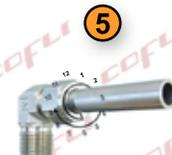
5. Haga una marca legible para determinar el punto de inicio para aplicar torque.
